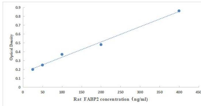
注：本图和标准曲线仅供参考，应以同批次试验标准品对应 OD 值绘制标准曲线，计算目的分子含量。
