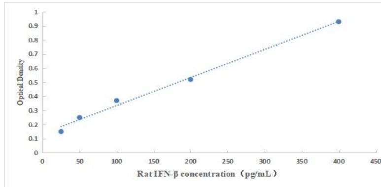
注：本图和标准曲线仅供参考，应以同批次试验标准品对应 OD 值绘制标准曲线，计算目的分子含量。
